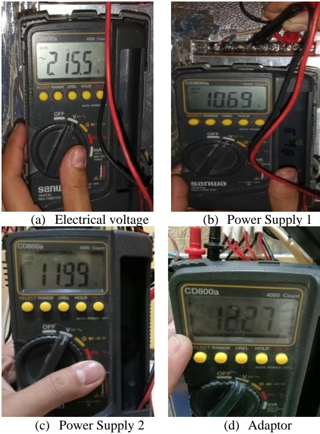
Gambar 17. Pengukuran tegangan power suplai
