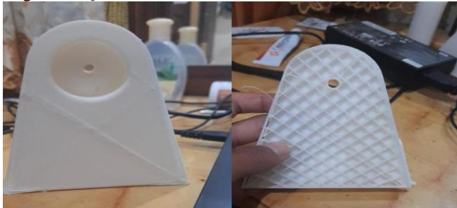
Gambar 11 Hasil Pencetakan Kaki Parallette pada 3D Printer
