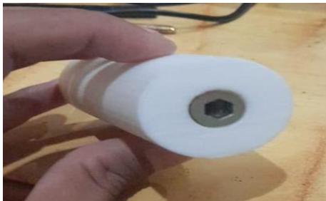
Gambar 12 Hasil Pencetakan Grip Parallette pada 3D Printer
